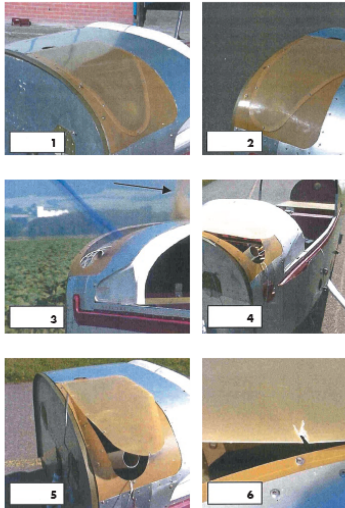
Varianta řešení průniku raketového motoru pláštěm letounu
